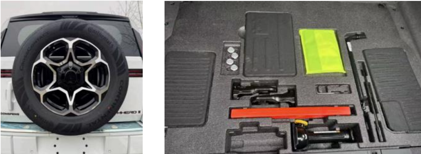
Pótkerék készlet (tartó + teljes méretű pótkerék + emelő)
